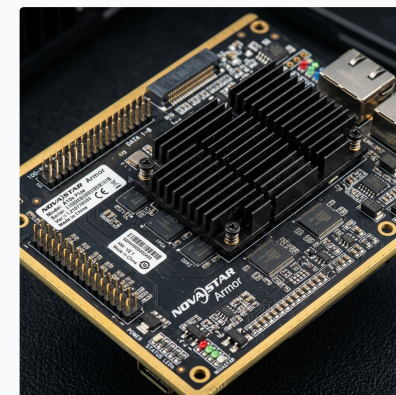
NOVASTAR ARMOR BROADCAST - DISSIPATORE DEDICATO PASSIVO IN ALLUMINIO
